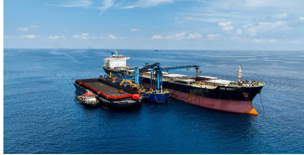
Proses pemuatan ke mother vessel menggunakan FTU
